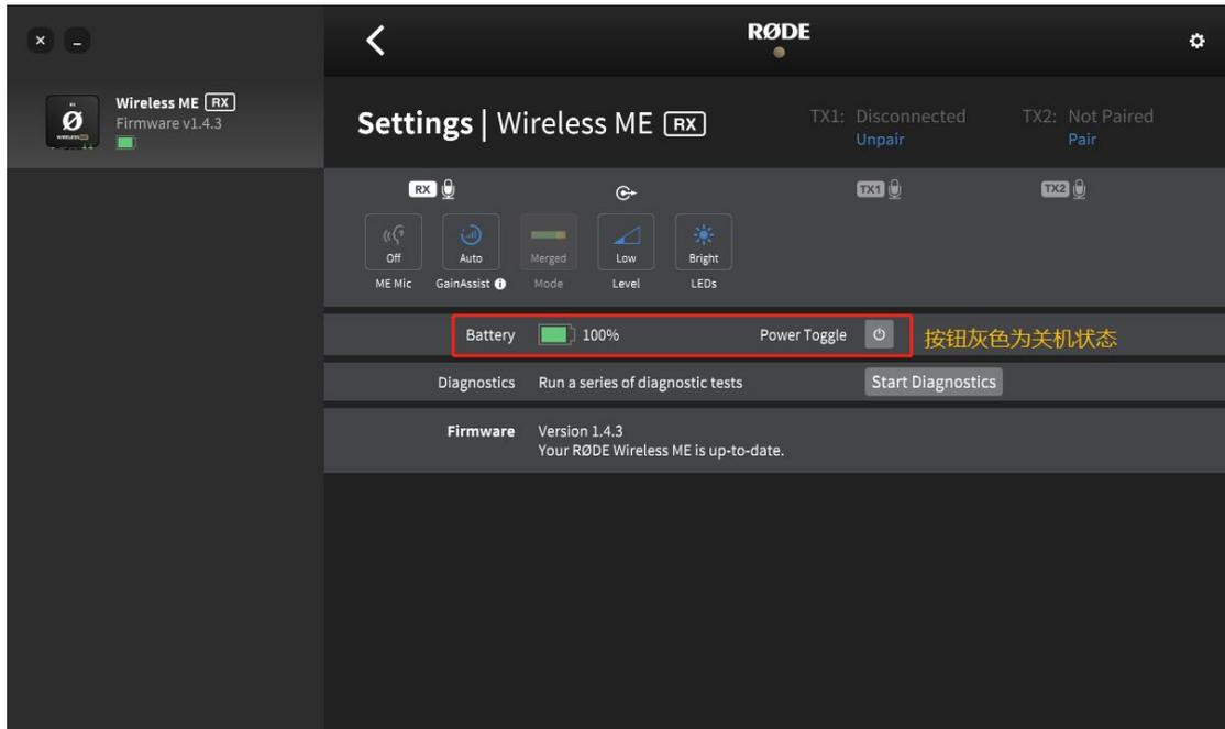
关机：在 RØDE Central（电脑端）中进入‘设置’（Settings）内找到‘电池’（Battery）选项，右侧图标显示为灰色表示设备为关机状态。无论设备是否与电脑连接，都将保持关机状态。
