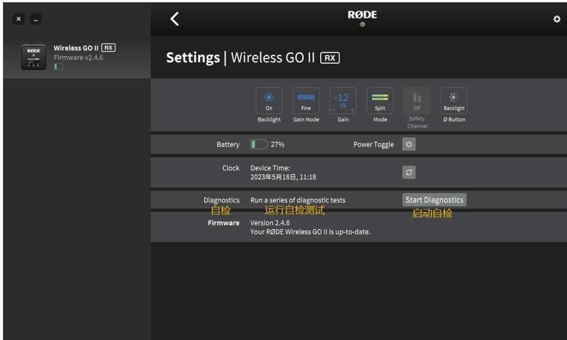
第一步: 在 RØDE Central 设置中找到‘自检’ (Diagnostics), 点击右侧的‘启动自检’ (Start Diagnostics)
