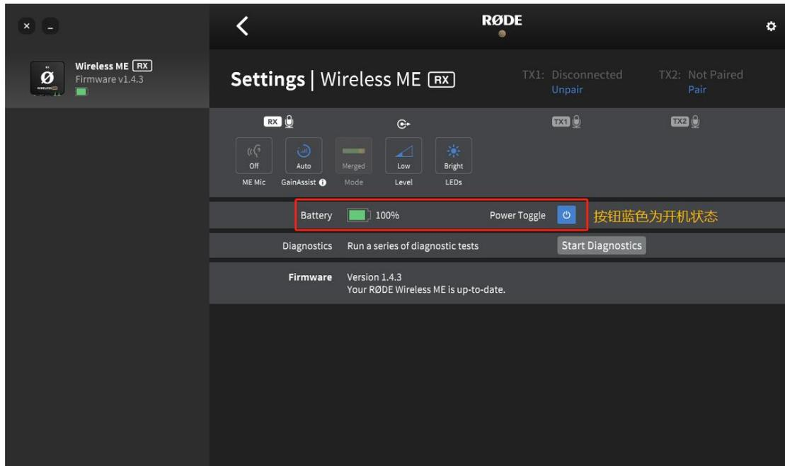
开机：在 RØDE Central (电脑端) 中进入‘设置’ (Settings) 内找到‘电池’ (Battery) 选项，右侧图标显示为蓝色表示设备为开机状态。无论设备是否与电脑连接，都将保持开机状态。
