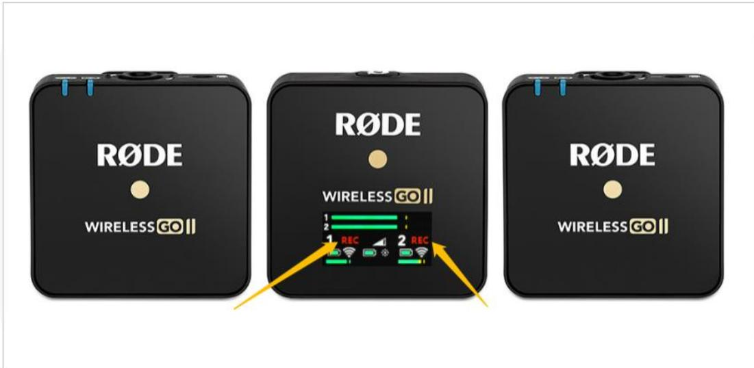
第二步：轻按一下发射器（TX）的开机键，当接收器屏幕上对应的发射器（TX）显示 REC 提示，即为**正在录音**；
