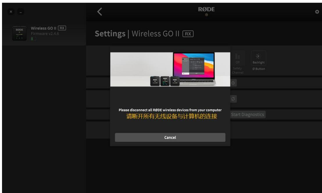
第三步：断开计算机已连接的全部 RØDE 设备。
