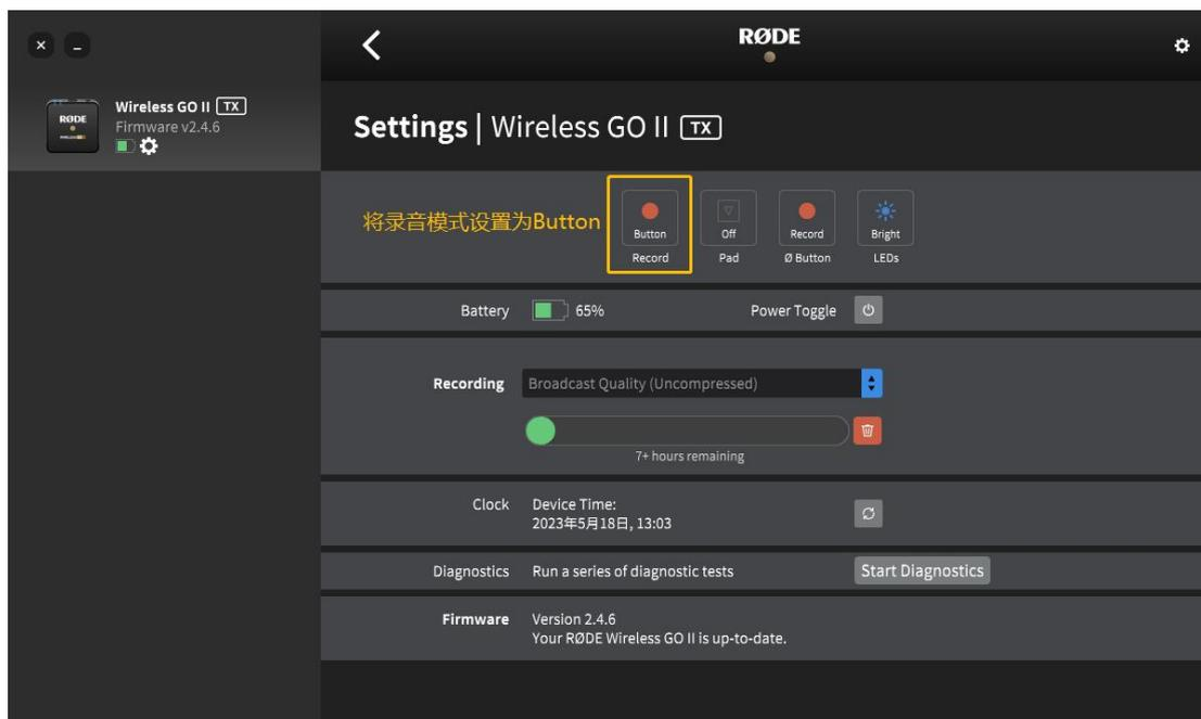
第一步：在 RØDE Central（电脑端及手机端均可）中进入‘设置’（Settings），将‘录音’（Record）设置为‘按键’（Button）。
