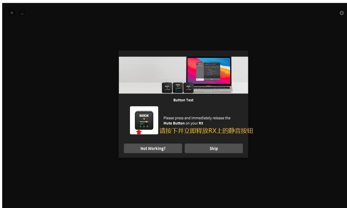
第九步: 进行'按键测试'(Button Test) - '请按下并立即松开 **RX** 的**静音按钮**' (Please press and immediately release the **Mute button** on your **RX**) 。
