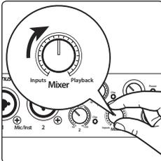
6. 请将AudioBox USB96前面板上的Mixer旋钮转到12点钟的位置。这将允许您从计算机听到输入和回放。
