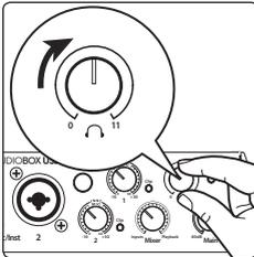
7. 请将一副耳机连接到AudioBox USB96耳机输出模式，并将Phones音量控制旋钮转到12点钟位置。
