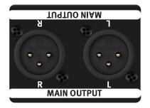
Am Main Output des MixDream XP MK2 wird der summierte Stereo-Mix ausgespielt. Dieser kann zum Beispiel über einen A/D-Wandler wieder in die DAW zurückgeführt und dort auf einer Stereo-Spur aufgenommen werden.
