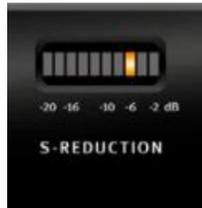
S-Reduction 控制器的 LED 显示可视化地齿音减少强度在0dB和-20dB之间，以2dB为单位。
