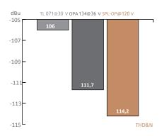
当涉及到音量时,120伏电压技术表现出的性能是普通元件和电路的两倍,在最大水平和动态范围方面,其数值大约高出10dB。SPL运算放大器的THD测量显示,与OPA134在36V时相比,差异超过3dB--就声压级而言,提升幅度在50%以上。
