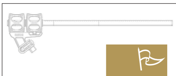
NTG8正确安装在SM8冲击安装(注意SM8方向)
