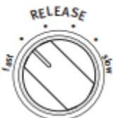
启动的对应是释放。释放参数决定压缩器处理信号的速度。
