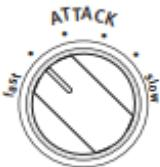
启动决定压缩机的响应时间。简单来说，它是压缩机在信号超过阈值后需要响应的时间。它表示压缩机完成63%工作所需的时间。启动时间可以分为六个步骤进行调整，从快到慢。
