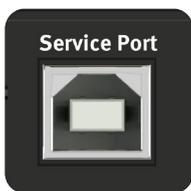
P8 可选 AD 转换器上的服务端口（USB）确保数字接口可以轻松维护。它用于传输操作软件（固件），并不用于音频连接。
