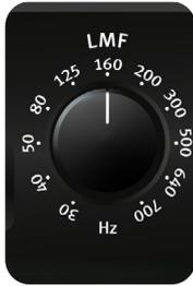
半参数中低频滤波器的中心频率由 LMF 控制器（中低频）设定。可调节的频率范围在 30 Hz 至 700 Hz 之间，因此该滤波器的覆盖范围约为 4.5 个八度音阶，可用于从最深的低音到中低音。这与 MHF 滤波器一起确保了整个频谱的覆盖。
