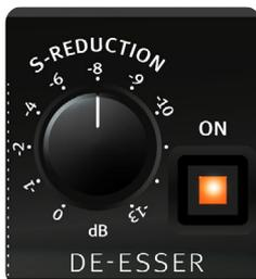
Mit dem Regler S-Reduction wird die Intensität der S-Laut-Reduzierung eingestellt.
