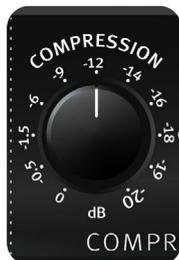
压缩控制可用于在 0 dB 和 -20 dB 之间设置阈值。阈值越低，压缩器的作用就越大。
