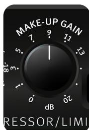
增益补偿控制可用于弥补压缩造成的整体电平降低。可设置 0 dB 至 20 dB 之间的值，通过该值，电平会在压缩后再次增加。
