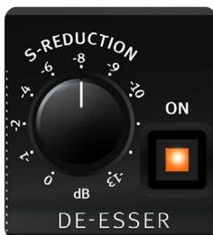
S-Reduction 控制器用于调整 S 音减弱的强度。
