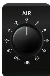
Das mit AIR bezeichnete Filter im EQ-Modul dient zur Bearbeitung des obersten Frequenzbereichs. Hier kommt ein Spulen-Kondensator-Filter mit einer Glockencharakteristik zum Einsatz, dessen Center-Frequenz bei 19 kHz liegt. Bei dieser Frequenz liegt die maximal mögliche Anhebung bei +10 dB, die maximal mögliche Dämpfung beträgt -10 dB.
