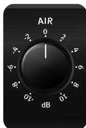
均衡器模块中的高频滤波器称为空气滤波器（AIR）。它是一种线圈电容滤波器，具有所谓的钟声特性，中心频率为 19 kHz。在此频率下，重音更达 +10 dB，阻尼可达 -10 dB。
