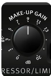
Mit dem Make-Up-Gain-Regler kann die durch Kompression hervorgerufene Gesamtpegelreduktion wieder aufgeholt werden. Es kann ein Wert zwischen 0 dB und 20 dB eingestellt werden, um den der Pegel nach dem komprimieren wieder angehoben wird.
