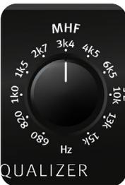
半参数中/高频滤波器的中心频率由 MHF 控制器设定。（MHF：中/高频）。频率范围可设置在 680 Hz 至 15 kHz 之间，因此该频率特性覆盖了 4.5 个八度音程，可同时用于中低频和高频。
